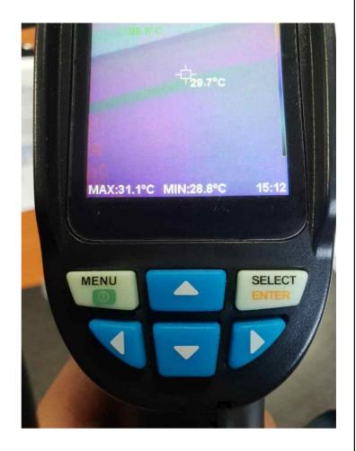
2. 전원 On-Off: HT-04-K는 일반인들이 사용하기 쉽도록 제작되었습니다. 전원버튼을 약 3~5초간 누르면 작동(ON)됩니다. 물론 끌 때도 동일(OFF)합니다. 3~5초간 길게 눌러야 전원이 On-Off되는 이유는 오작동을 방지하기 위함입니다
