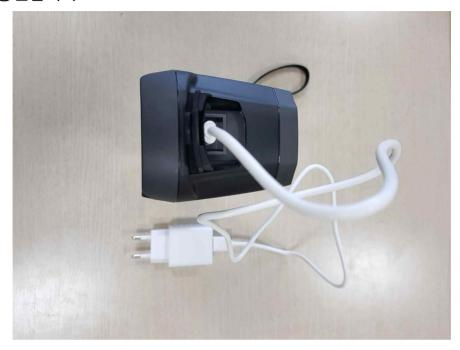
2. PC 연결: 제품 상단부 USB 포트와 PC에 USB 연결 케이블을 연결하면 PC에서 일반 이동식 메모리로 인식하게 됩니다. PC에서 해당 이동식 디스크를 클릭하면 저장되어 있는 이미지 확인 및 편집이 가능합니다.
